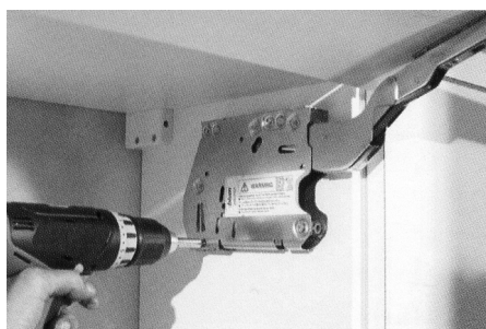
Finjustering med skruvdragare
